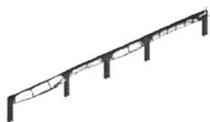
图9 3轴纵梁第一阶屈曲模态
