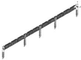
图7 3轴纵梁有限元模型
