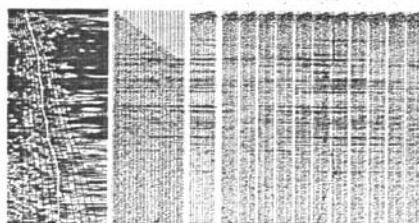
图1 PROMAX软件速度谱分析速度及质量控制 Fig.1 Velocity spectrum analyzing velocity and QC in PROMAX
