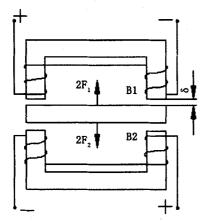
图1 磁悬浮轴承模型
