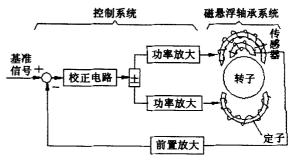
图3 磁悬浮轴承的控制系统
