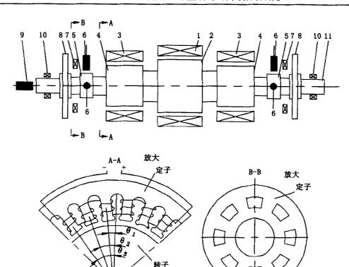
图2 磁悬浮轴承装置的结构原理
