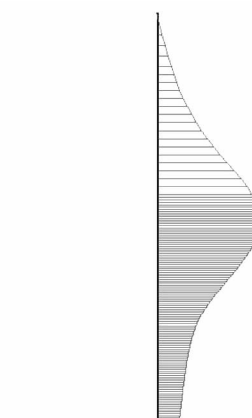
图2 围护结构变形水平位移图
