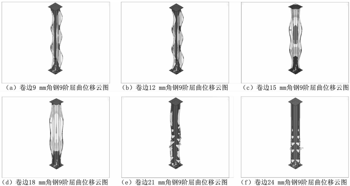
图3 不同卷边宽度加劲角钢构件屈曲模式对比图
