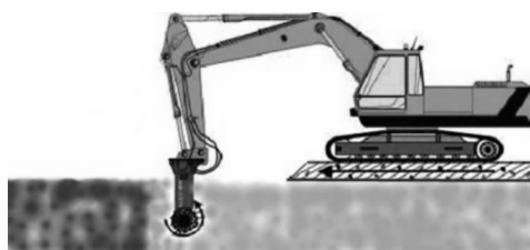
原位垂直上下固化式适用于强度较软的淤泥土
