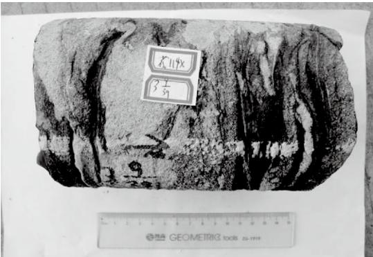
(c) 砂砾岩中发育揉皱构造, 含有泥砾和泥质条带
