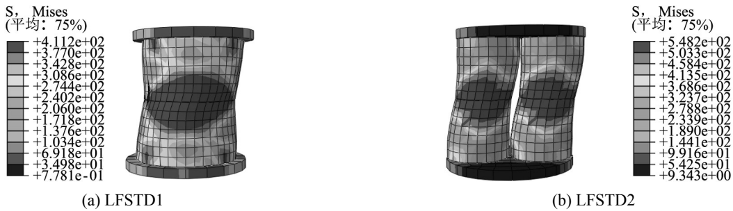
图 7 钢管铅芯阻尼器应力分布云图 Fig.7 Stress map of the LFSTD
