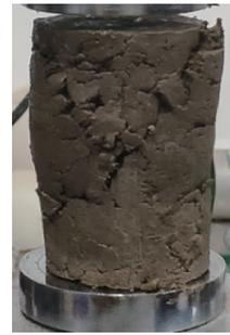
图 2 试样破坏形态图
