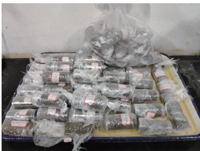
图 1 固化污泥土试样
