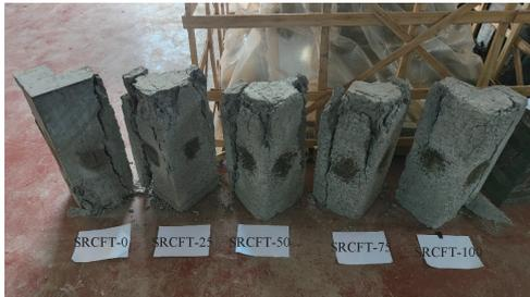
图 4 构件破坏对比图
