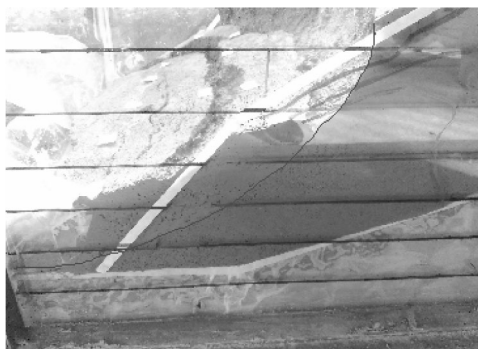
图5 第十天后壁拉张裂缝
