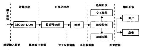
图2 地下水敷据可视化流程图 Fig. 2 Groundwater data visual flow diagram
