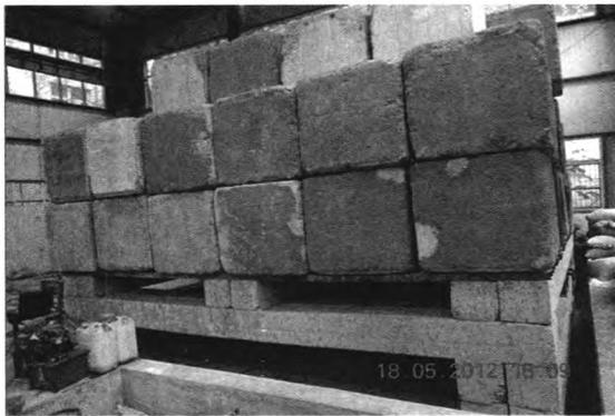
图1 载荷试验现场
