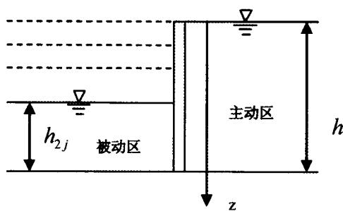
图1 基坑分步开挖示意图
