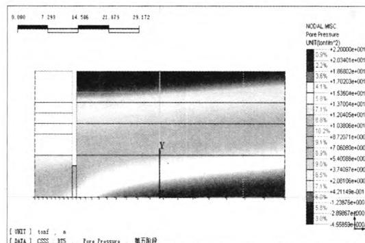
图5 第五阶段孔隙水压力等值线
