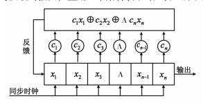
图1 右移型线性移位寄存器的构成
