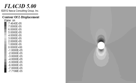
图 4 洞室 Z 方向位移云图
