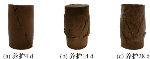
图4 相同掺量不同养护时间试样破坏形态
