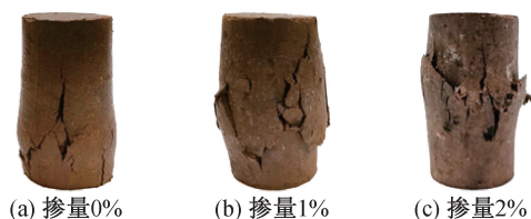
图5 相同养护时间不同黄原胶掺量试样破坏形态
