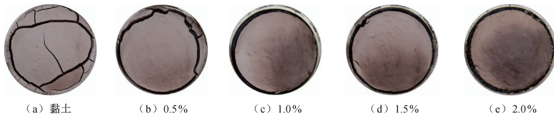
图5 不同生物聚合物掺量改良土开裂试验结束后的裂隙发育图
