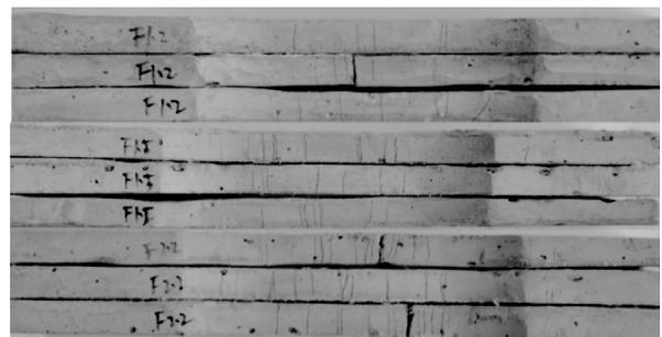
图6 不同粉煤灰掺量HDCC的多缝开裂情况
