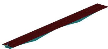
图 3 变截面连续箱梁桥有限元模型
