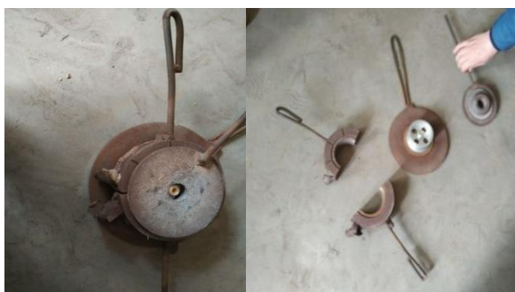
图 2 原工厂的金属模 (a) 合模状态 (b) 开模状态
