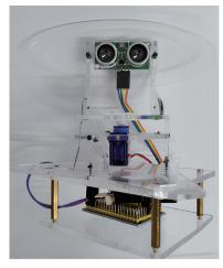
图 3 超声雷达硬件图
