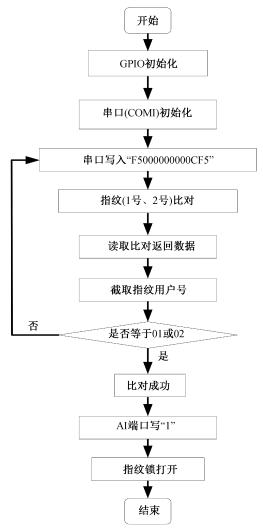
图 4 指纹识别程序流程图
